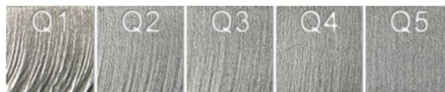
Die Rauheit der Schnittkante nimmt mit der Blechstärke zu (Laser- und Plasmaschnitt)
